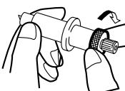
Ziehen Sie die Kontermutter wieder an, um die Einstellschraube zu sichern.
